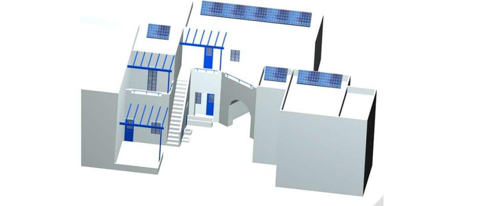
**HYBRID PV/T COLLECTORS ON CYCLADIC HOUSE ROOF**
