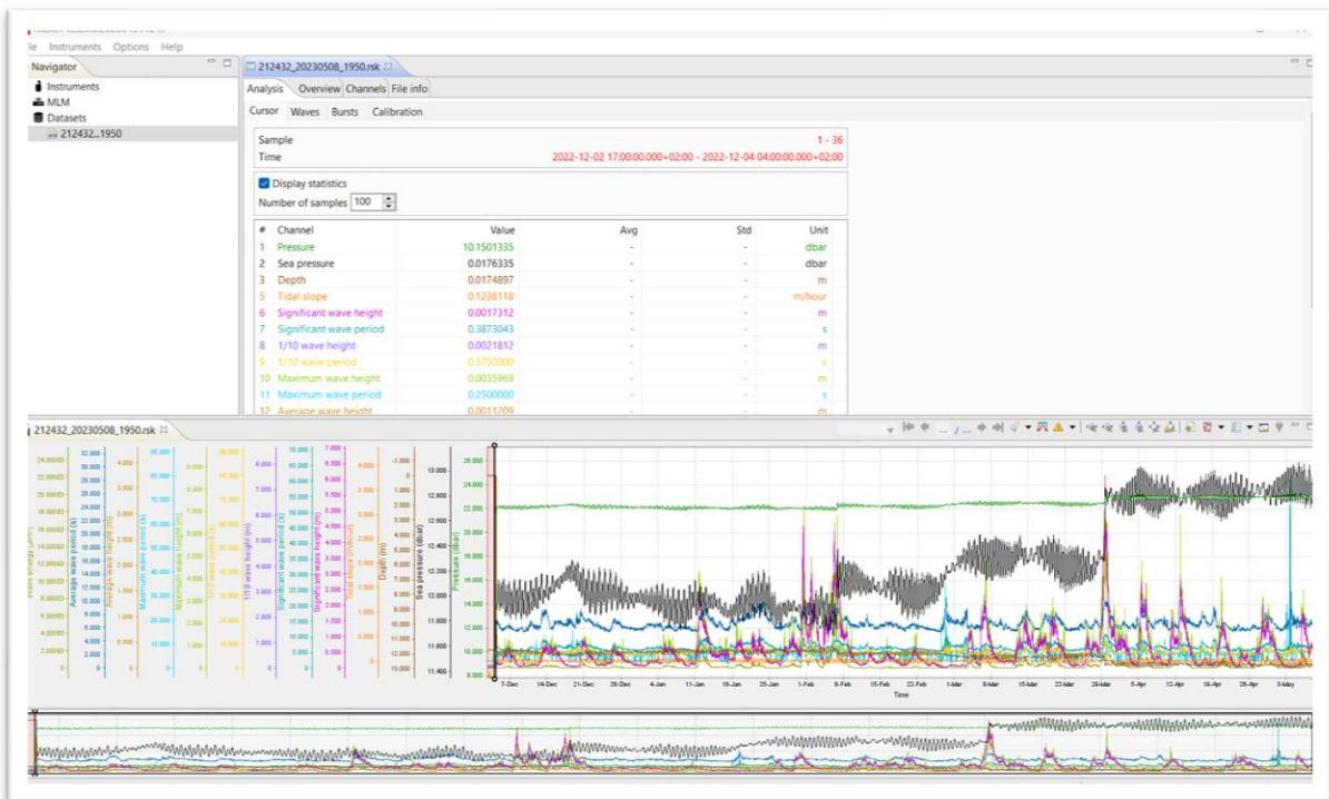
**Εικόνα 1:** Το λογισμικό Ruskin που χρησιμοποιείται για την εξαγωγή και πρώτη οπτικοποίηση των δεδομένων από τους κυματογράφους RBR.
